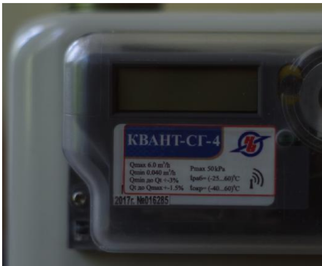
Рисунок 2 – Маркировка счетчика газа диафрагменного КВАНТ-СГ-4
